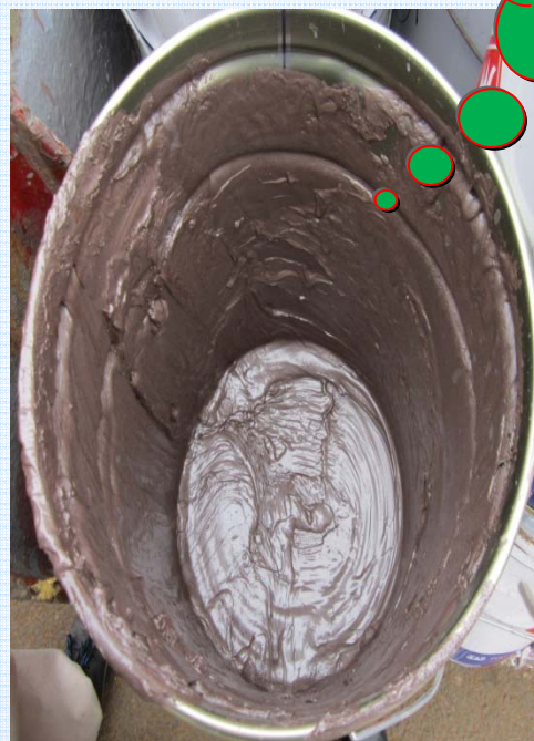
图18 未刮净的普通包装油漆桶
