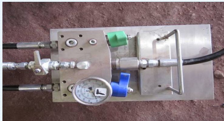
图12 混合器，主机固化剂在此混合
