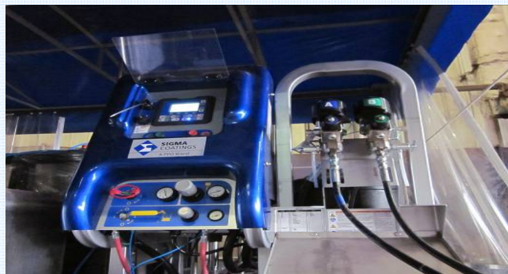
图13 大包装喷涂设备的控制计量系统
