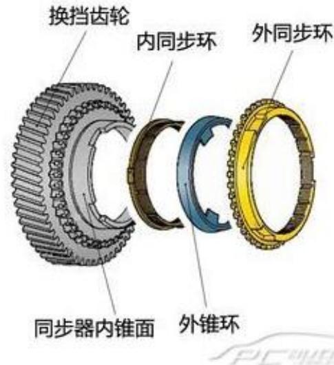
同步器是改善汽车机械式变速器换挡性能的主要零部件，对减轻驾驶员的劳动强度，致使操纵轻便，提高齿轮及传动系统的平均使用寿命，提高汽车形式安全性和舒适性，并对改善汽车起步时的加速性和经济性起着极其重要的作用。
