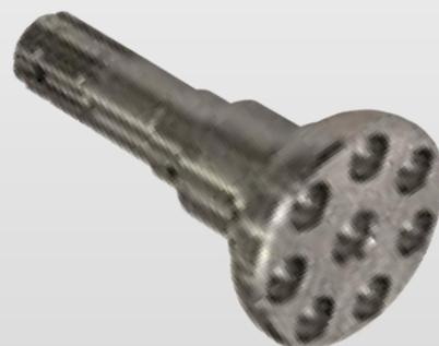
传统加工方法：中心球窝车削，周边球窝铣削，效率低下
