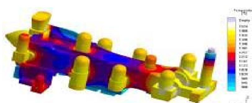
利用MAGMA对车钩进行铸造工艺分析
