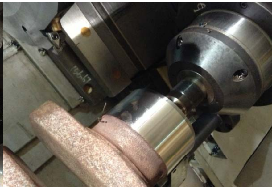
曲轴轴颈车削加工
