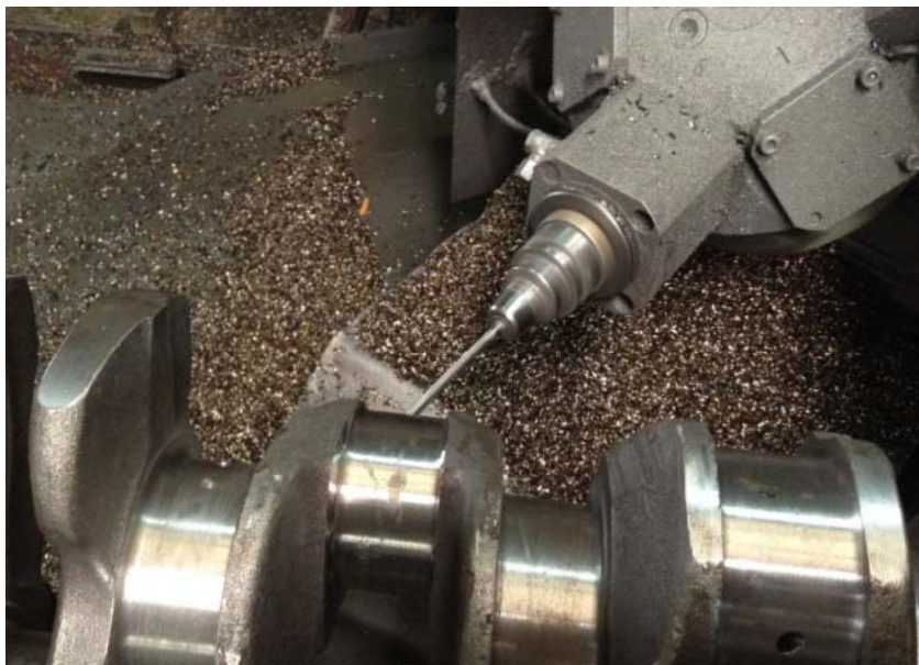
曲轴油孔钻削加工
