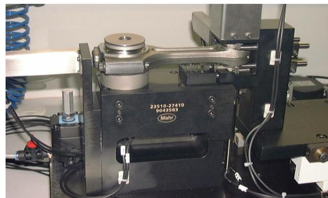
可根据实际测量需求，测量连杆孔径、中心距、平行度、扭曲度、垂直度等
