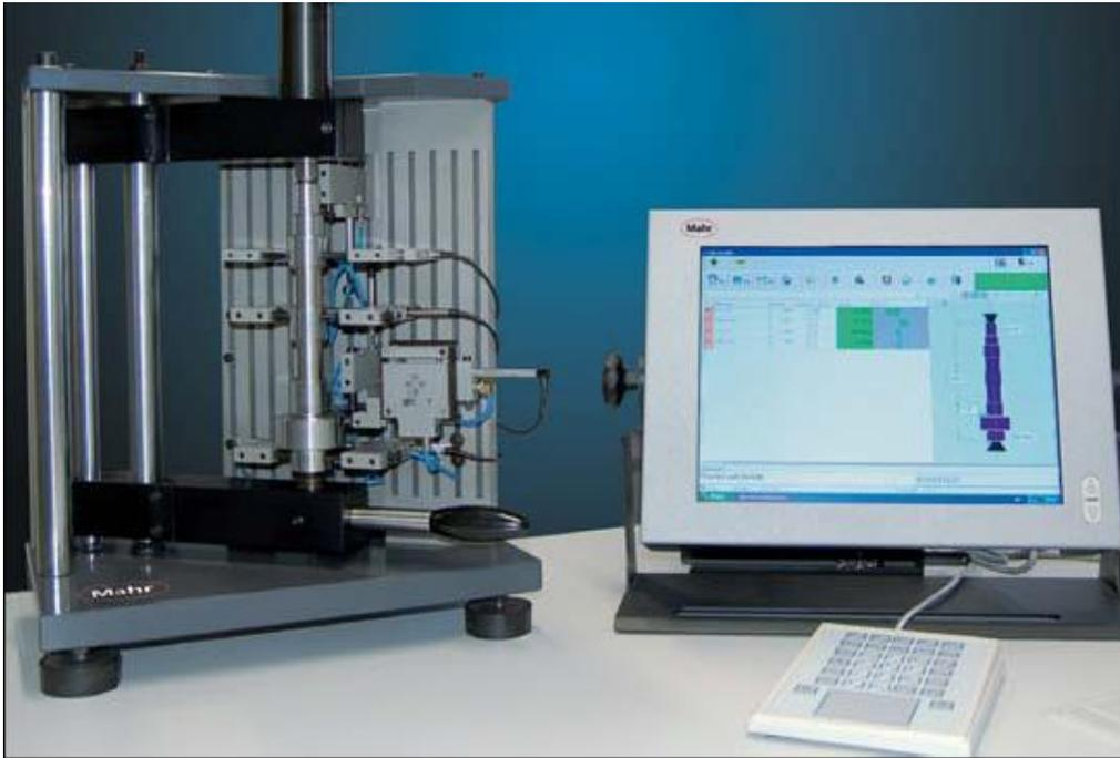
轴类工件检测方案——采用电感测量系统，多个电感测头对指定位置进行检测，通过多输入通道控制箱，与计算机相连接，由SPC软件对测量数据进行后期处理
