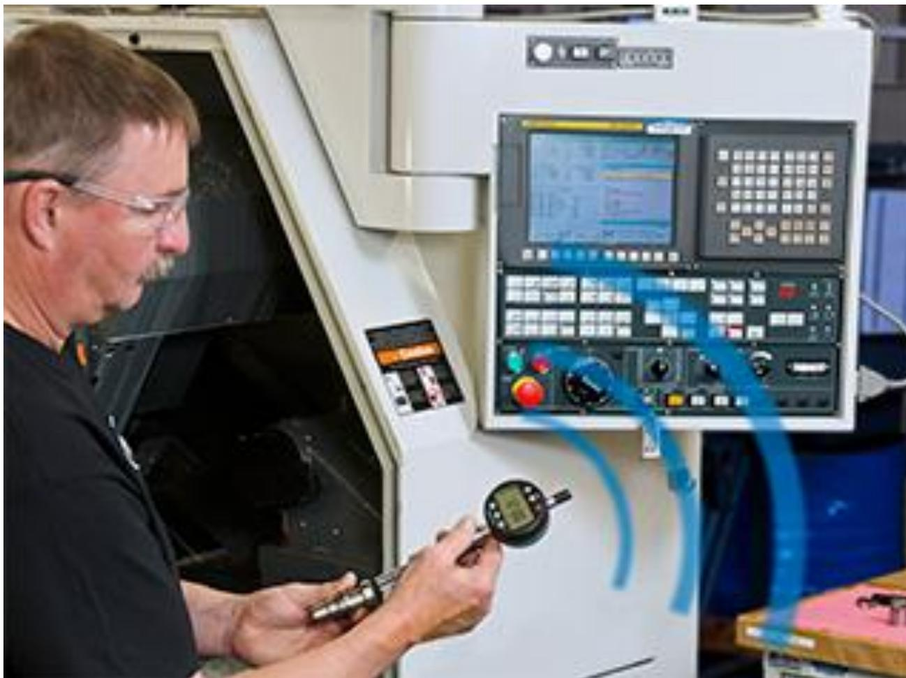
机床内检测工件并将测量数据传输给加工中心，方便、快捷。
