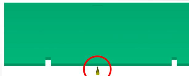
铭牌位置的壁厚增加0.3mm，并将浇口位置减少1个，以减少熔接线。
