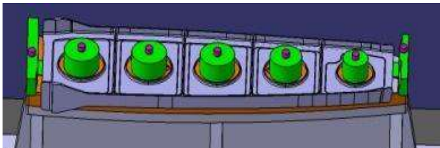
图2.11 真空平台吸附薄壁结构件
