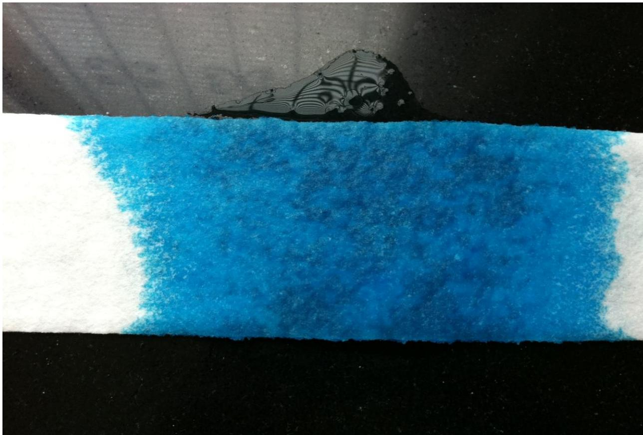
含SAP的复合吸水纸芯体（加液60g）就开始侧漏
