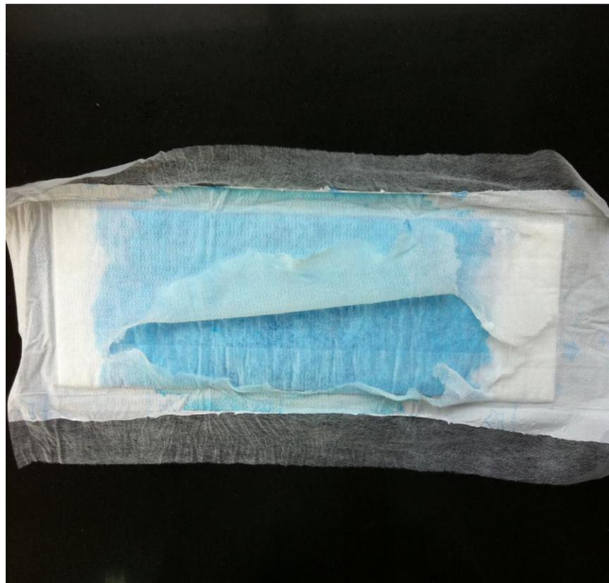
含SAP的复合吸水纸芯体（无导流层纸尿裤产品）
