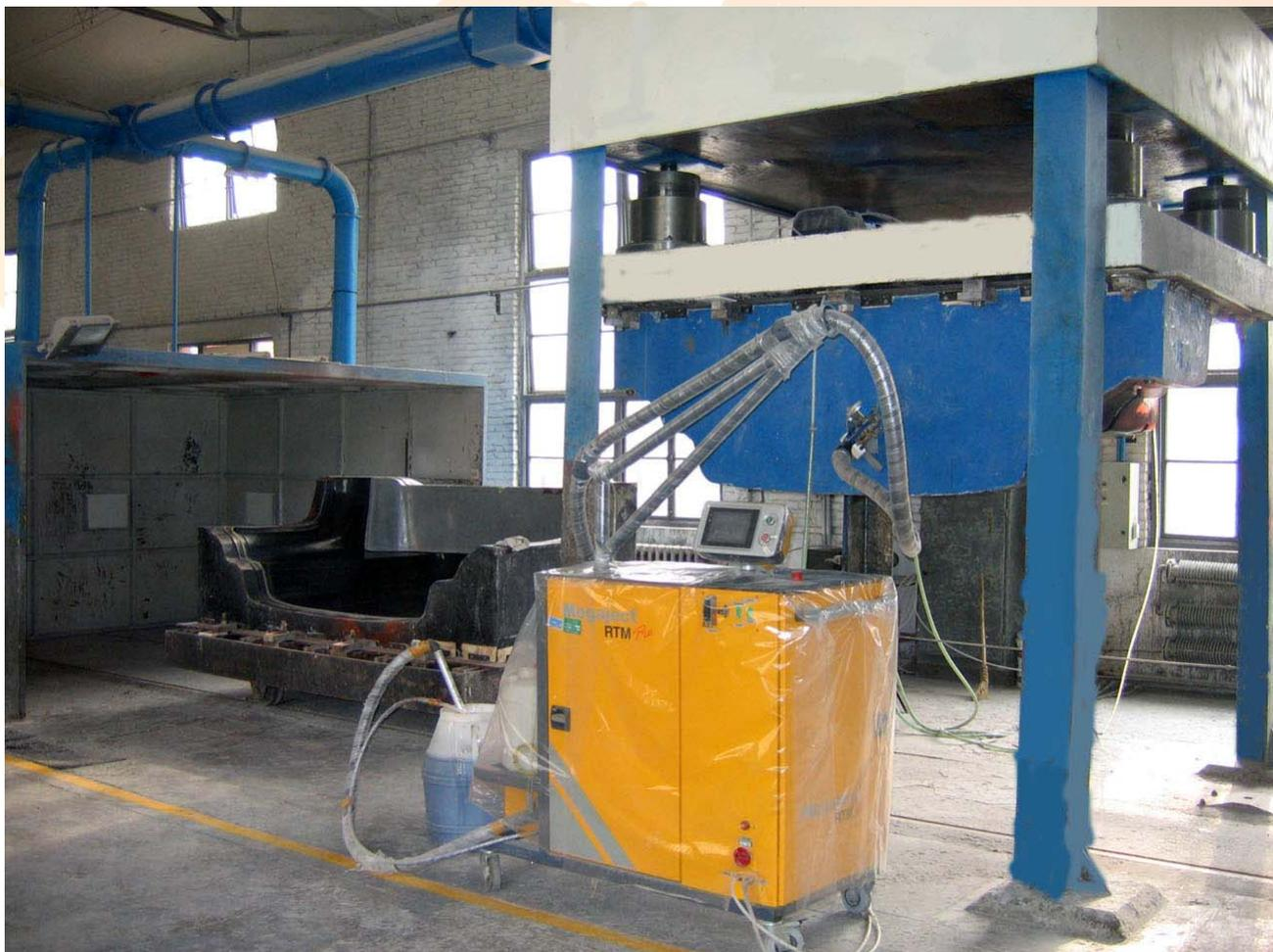
卡车发动机罩RTM生产线
