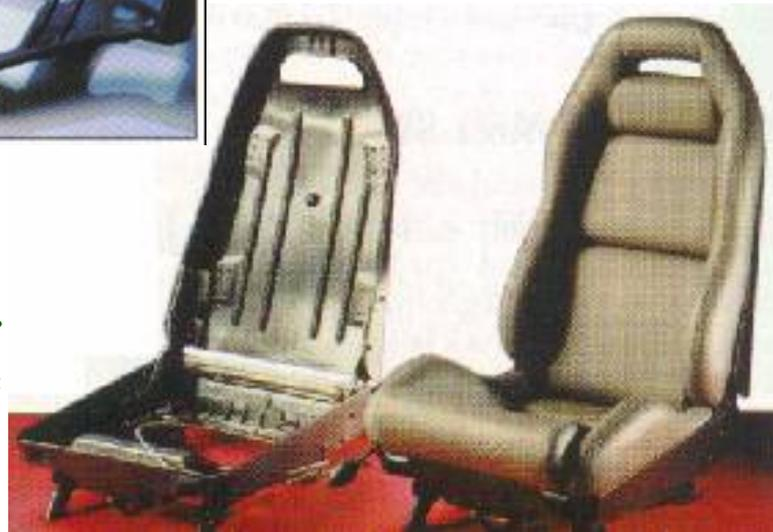
特征LFT → 调整LFT的力学性能 → 代替金属制作结构部件
