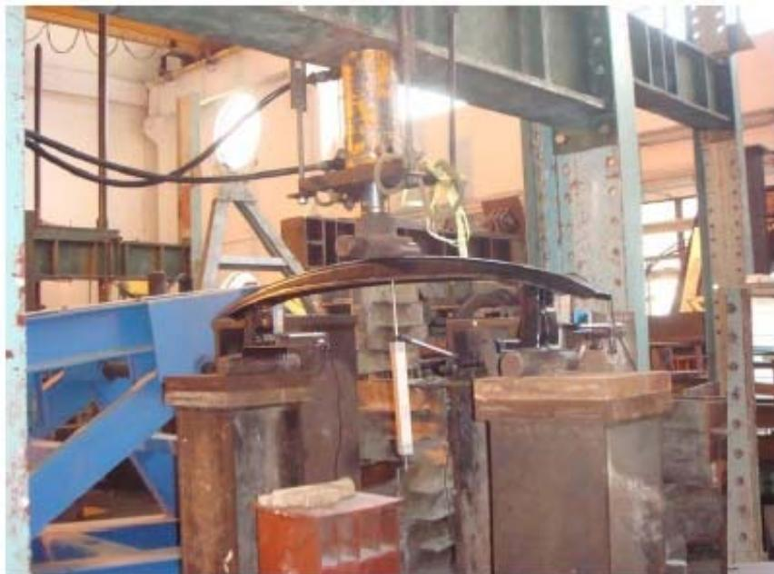
图2 钢材保险杠缓冲梁试验装置 (Polo)
