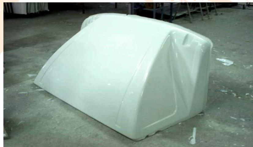
采用轻质RTM工艺制作导流罩
