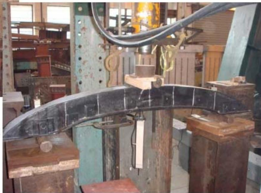
图3 GMT保险杠缓冲梁试验装置 (东方之子)
