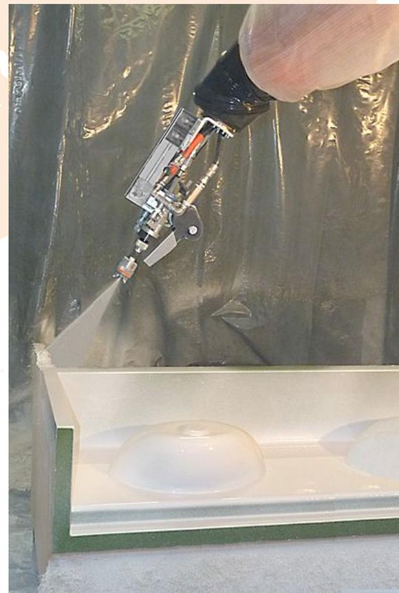
工业机器人自动喷射成型
