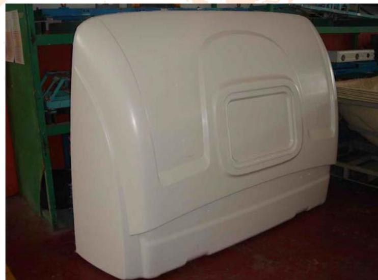
采用高速RTM工艺生产高顶
