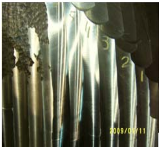
特殊铣头加工大型螺旋桨实验
