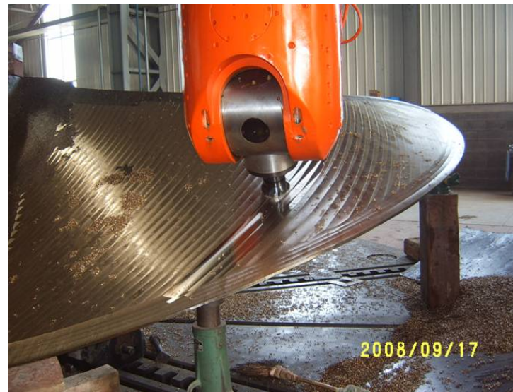
刀具姿态、工件支撑与切削 过程稳定性密切相关
