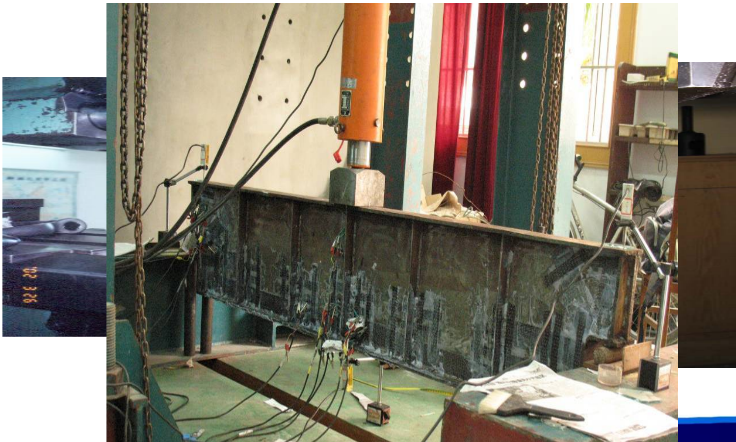
吊车梁模型加固后疲劳试验
