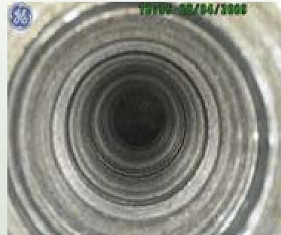
因枪钻是偏心的，故必须配有钻套，而采取微量润滑后，改为双刃高速钢麻花钻就不再需要钻套。另外，由于微量润滑的油雾本身质量就很小，且因加工中受力对称，形成的孔壁就较光滑（见下图）。相应的工艺试验则表明，应用微量润滑还明显地改善了工件清洁度，这是因为此时切屑将更容易在加工中排出，有利于切屑回收，而且在清洗过程中也更不易残留。事实上，这种切削可以认为是准干式的，相比传统方式不但使用成本更低，且雾化的润滑油也更利于油膜的建立。
