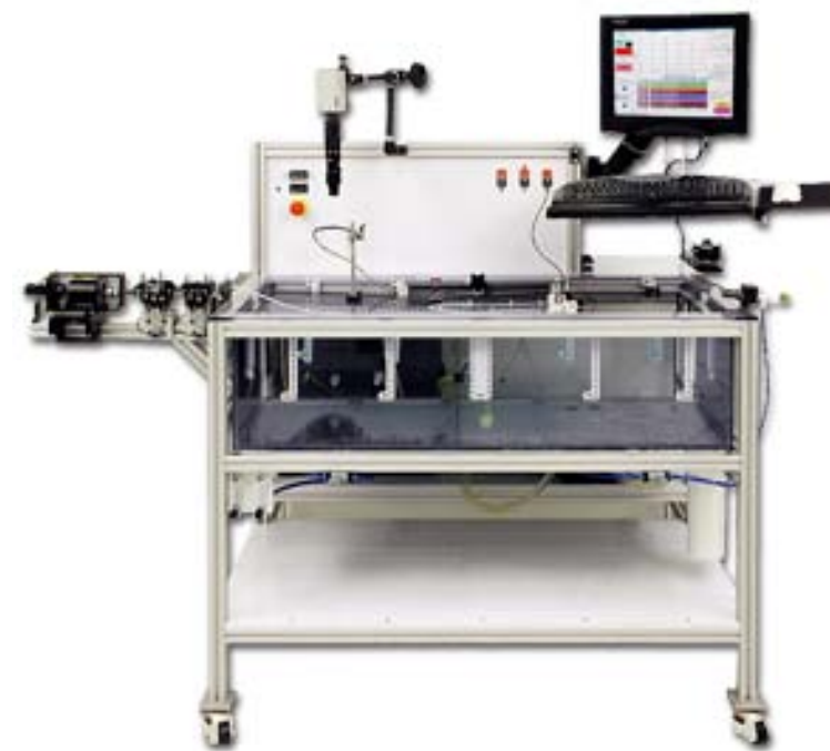
导管性能测试平台
