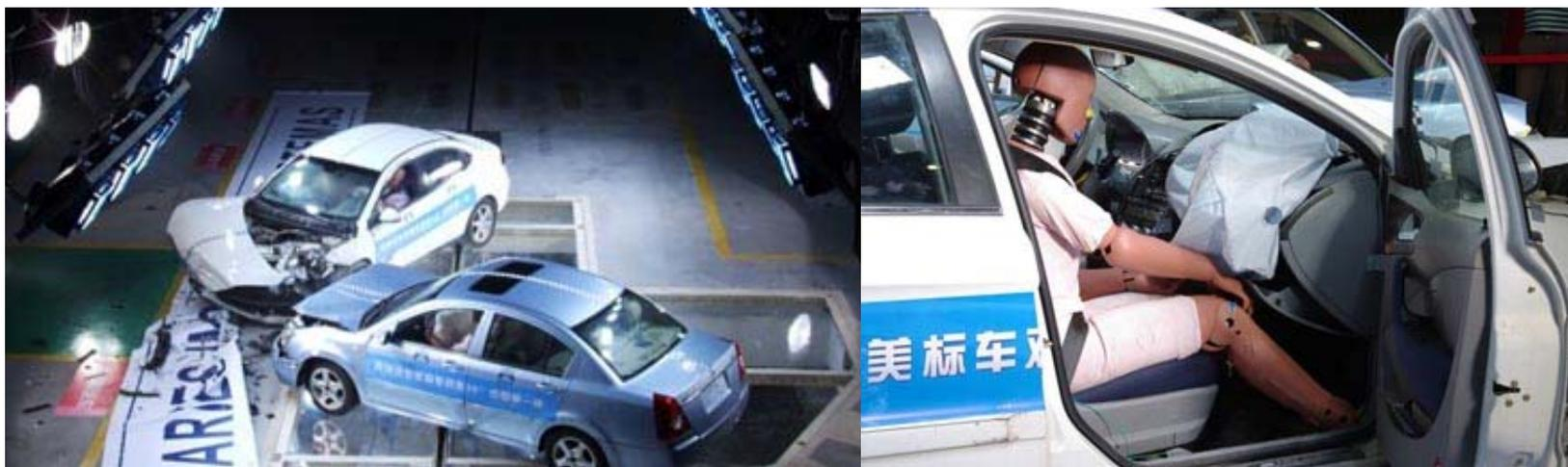
美标30° 车对车角度碰撞试验
