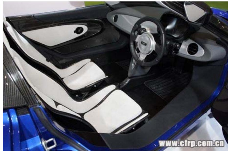
日本东丽电动汽车**TEEWAVE AR1**概念车使用了约**0.16吨**的碳纤维增强树脂材料，在超越普通同款式车辆的刚性、碰撞安全性的同时，减少了**0.55吨**左右的钢板用量。
