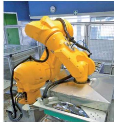
图示：TX200机器人高速精确搬运托盘。
