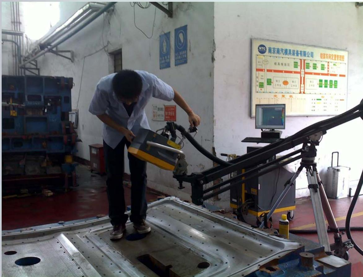
在车间内现场测量模具型面数控加工误差
