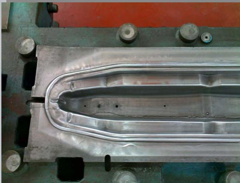
汽车厂家的一付长期使用已经开裂报废的进口模具。需要复制一付但其无法提供原始模具CAD数据
