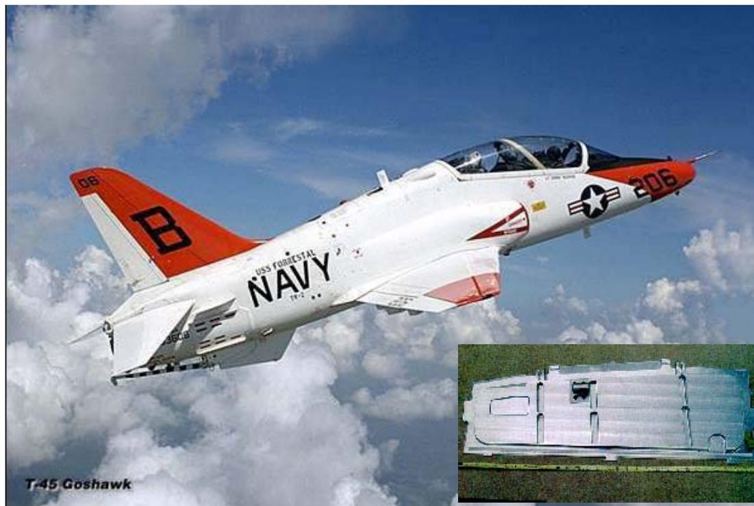
波音公司在航空领域，首先将搅拌摩擦焊应用于美国空军现役T45教练机起落架制造
