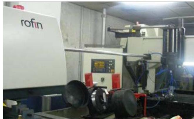
双光束CO<sub>2</sub>激光焊接系统
