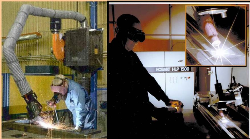
常规熔焊方法焊接铝合金时，容易出现气孔、夹渣、裂纹等焊接缺陷，焊接质量稳定性差，且现场作业环境极恶劣（强辐射、高温、烟雾、飞溅）。
