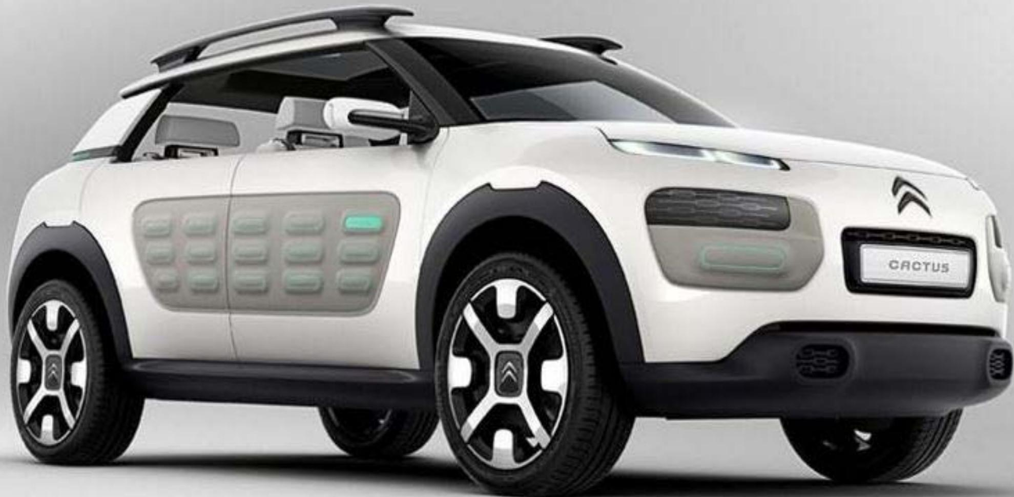
雪铁龙C4 Cactus的外侧面板安装了充气保险杠，采用热塑性聚氨酯制成。据称，这种材料可以从20毫米压缩状态马上弹回至原来的形状。
