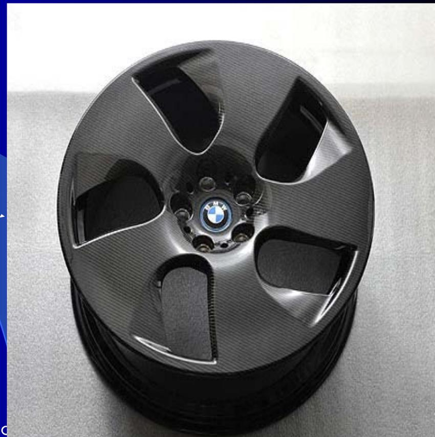
可替代金属和铝合金等传统材料从而实现降低重量，并有可能进一步降低制造成本。目前单是在汽车行业，就已经有若干家设备制造商对碳复合材料车轮应用表现出兴趣。
