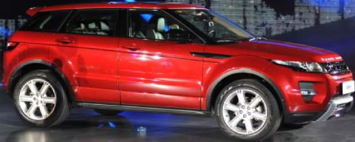
路虎揽胜极光，采用了一系列高级轻质材料，比如像PA/PPO合金应用于前翼子板，PC/PBT合金应用于行人保护吸能块，并将长玻纤增强聚丙烯应用于仪表板及内门模块；使自重小于1.6吨，比揽胜运动版轻了35%，二氧化碳排放量低于130克/千米。
